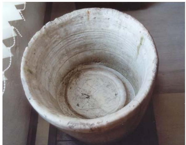
Abb. 4: Glasschmelzhafen der Glashütte Alt Schwerin (1847-1901) mit innen liegendem Schwimmring Fotos: Moths, Geesthacht
